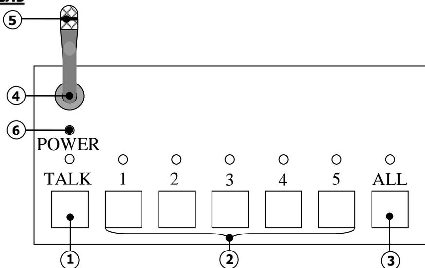
**1. Кнопка и светодиод (TALK):** Кнопка TALK предназначена для подключения звукового тракта микрофона к моноблоку. При нажатии данной кнопки происходит коммутация звукового тракта с входа AUX (ПОЗ 8 задняя панель) на микрофон. Подключение микрофона дополнительно отображается светодиодным кольцом на гусе микрофона (ПОЗ 5).
