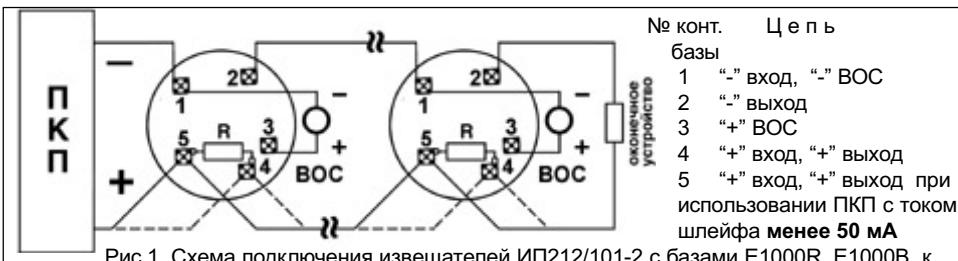
Рис.1. Схема подключения извещателей ИП212/101-2 с базами Е1000Р, Е1000В к ПКП. В базе Е1000В резистор и 4-й контакт не установлен.
