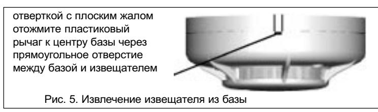
Рис. 5. Извлечение извещателя из базы
