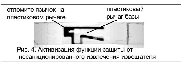
Рис. 4. Активизация функции защиты от несанкционированного извлечения извещателя
