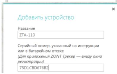
В появившейся вкладке «Добавить устройство», укажите **Название** терmostата, например ZTA-110, введите его **Серийный номер** (указан на плате прибора под крышкой) и нажмите кнопку «Добавить»
