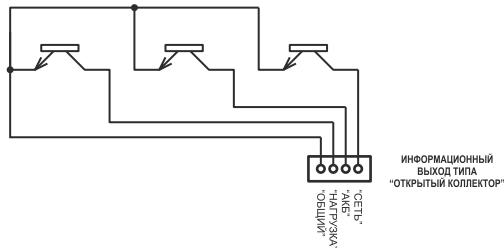
Все выходы "открытый коллектор" работают относительно выхода "ОБЩИЙ" информационного разъема.
