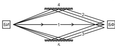
**Интеллектуальный режим обработки ИК сигнала** позволяет отличать прямой и переотраженные ИК лучи, попадающие на оптическое окно БФ, и формировать извещение о тревоге при пересечении прямого ИК луча при мешающем воздействии переотраженных ИК лучей.
