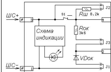
**Включение извещателя в шлейф сигнализации со знакопеременным напряжением с квитиowaniem приборов типа УСПП-01Л «Сигнал-42-01» или аналогичных.**
