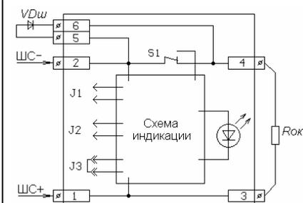
**Извещатель с нормально-замкнутым контактом в шлейфе сигнализации без квитирования.**
