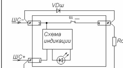
**Включение извещателя в шлейф сигнализации без квитиования приборов типа «Нота», «Радуга» и аналогичных.**
