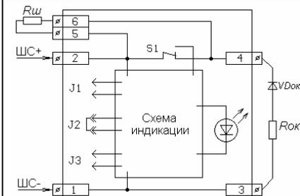
**Извещатель с нормально-замкнутым контактом в шлейфе сигнализации со знакопеременным напряжением с квитированием.**
