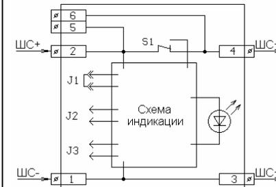
**Извещатель с нормально-замкнутыми контактами в шлейфе сигнализации со знакопеременным напряжением с квитированием.**
