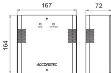
Блок питания обеспечивает зарядку аккумуляторной батареи емкостью 7А\*ч., устанавливаемой потребителем в корпус источника током до 1,0 А и поддерживает ее в заряженном состоянии при наличии сетевого напряжения от (~) 110В до 250В.
