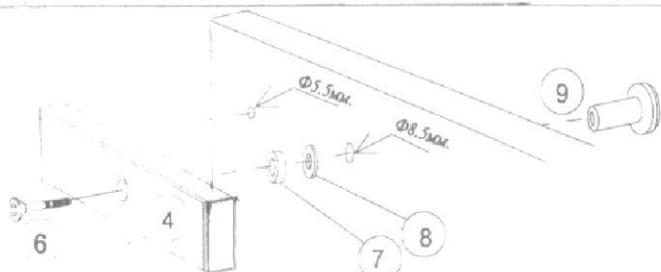
При закрытой двери разметьте по прилагаемому шаблону места якоря и замка, а затем просверлите на двери посадочные отверстия для якоря 4 и фиксатора. Закрепите якорь 4 на двери с помощью винта 6 и пятки 9, не забыв при этом поставить шайбы 7 и 8, обеспечив люфт якоря 4-5 мм. относительно винта 6.
