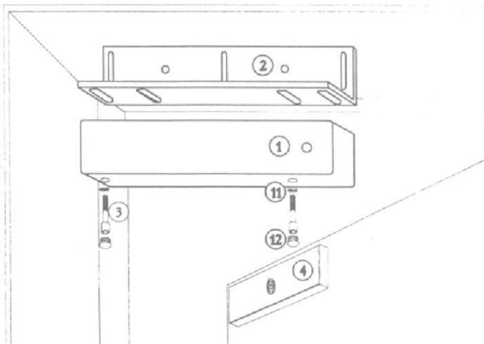
Просверлите посадочные отверстия соответствующего диаметра под винты диаметром 8 мм.. С помощью винтов закрепите уголок 2. Спецгайками 10 и винтами 3 соедините замок 1 с уголком 2, предварительно пропустив провода управления и питания в отсек электроники.
