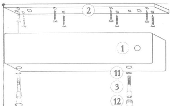
При монтаже замка на двери с планкой разметьте по прилагаемому шаблону место для крепления планки 2. Укрепите планку на двери саморезами. С помощью винтов 3 присоедините замок 1 к планке 2. И, наконец, забейте заглушки 12, закрыв крепежные отверстия.
