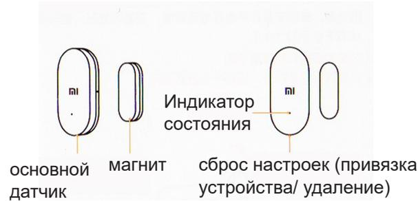
Датчик для окон/дверей состоит из основного датчика и магнита, которые устанавливаются вблизи друг от друга и фиксируют изначальное состояние окон или дверей. Низкое энергопотребление, простая установка без дополнительных инструментов, установите и сразу же используйте.
