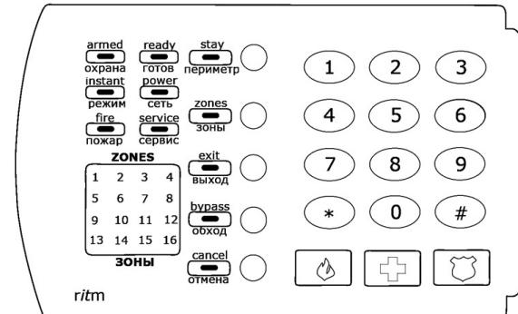
Световая индикация в дежурном режиме дублирует индикацию охранных панелей «Контакт GSM-10». Для экономии заряда батареи индикация на клавиатуре включается после нажатия любой из клавиш и горит в течение 15 секунд после последнего нажатия.
