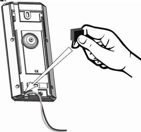
11. Установите детектор на кронштейн и зафиксируйте винтом.
