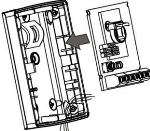
**8** Закрепить подведенные провода в клеммах извещателя.
