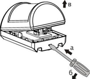
**2** Отогнуть зацепы на основании. Снять плату
