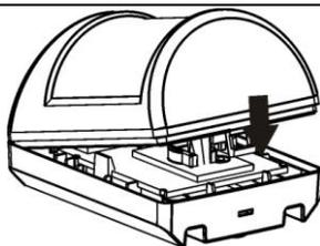
18 При тестировании системы сигнализации в начальный период эксплуатации (1-2 недели) в случае выдачи ложных извещений "Тревога", связанных с особенностями охраняемого помещения, снять переключку с вилки Sens
