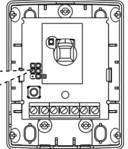
**11** Включить питание извещателя, при этом индикатор мигает **1 раз в 1 с** в течение не более 60 с – выход извещателя на рабочий режим
