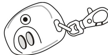
Брелок применяется для постановки и снятия системы с охраны. Позволяет также подать сигнал тревоги паники – одновременным нажатием обеих кнопок. Функция тревоги паника включаемая – см. "Настройки". Срок службы батареи брелка около 2 лет. Сигнал регистрации высылается при нажатии обеих кнопок одновременно в течение 3 секунд.
